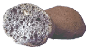
Figur 2.2 Lättklinkerkula i genomskärning (Maxit, 2007)
